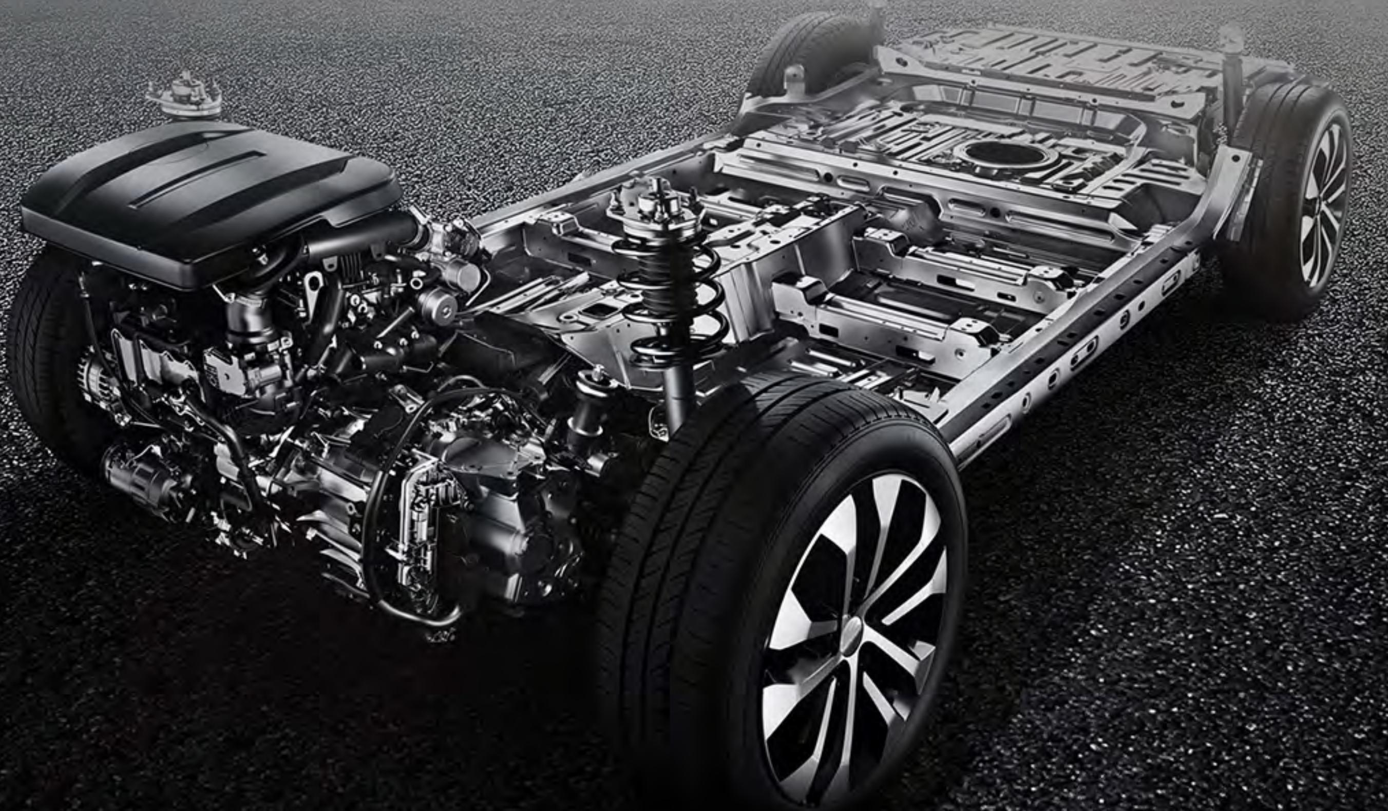
В основе OMODA C5 лежит модульная платформа T1X. Передняя подвеска – независимая McPherson, задняя – полузависимая пружинная, с гидравлическими телескопическими амортизаторами. OMODA C5 выгодно отличается от конкурентов длинной колёсной базой (2630 мм) и внушительным дорожным просветом (190 мм).
