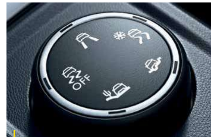
СИСТЕМА INTELLIGRIP Система интеллектуального привода IntelliGrip 2 обеспечивает надежное сцепление с дорогой вне зависимости от покрытия. Гравий, грязь или снег? Выберите один из пяти режимов на селекторе и предоставьте остальное Grandland X:
